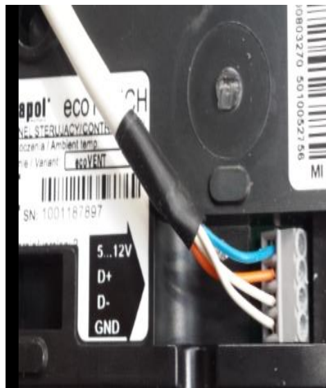
Rysunek 8. Sposób podłączenia elektrycznego przewodu sterującego do panelu ściennego
