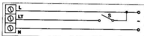
Schemat podłączenia wentylatora wyposażonego w wyłącznik czasowy / wyłącznik czasowy z czujnikiem wilgotności i z wbudowanym wyłącznikiem rys. 3.3.
